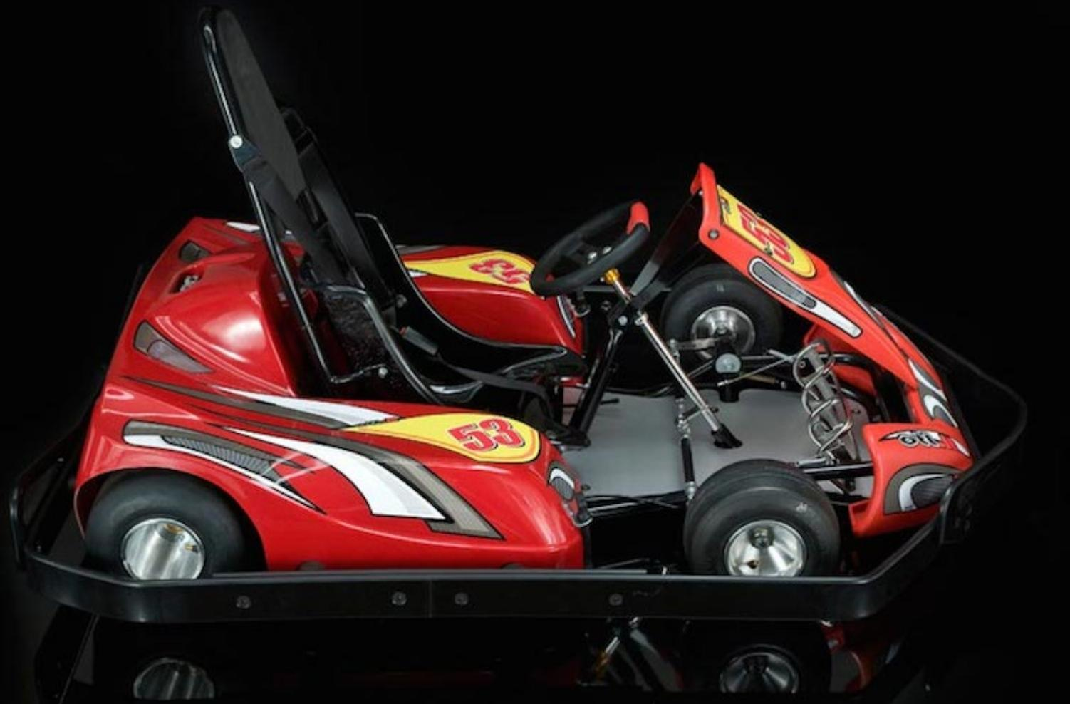
Questo modello di kart è equipaggiato con un motore elettrico in corrente continua ed è privo di differenziale. È adatto per bambini alti minimo 120 cm. Utilizzando un sedile di riduzione in poliuretano e degli speciali pedali di riduzione (forniti come accessori), possono pilotare il kart anche i bambini più piccoli.
