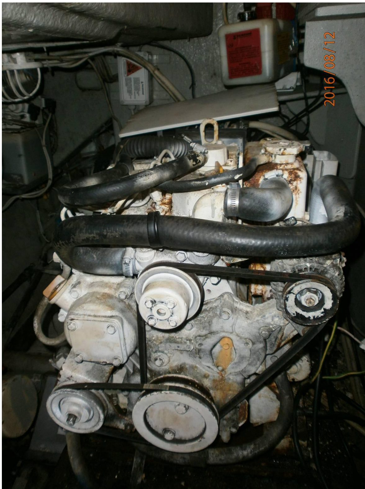
Foto n.19 – Imbarcazione “Again We All ” – Il generatore presente in aggraccio timone
