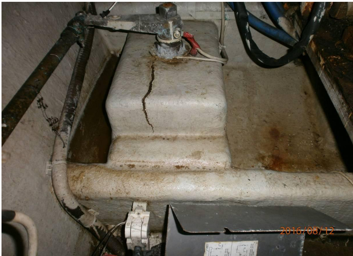
Foto n.16 – Imbarcazione “ Again We All ” – La cricca della struttura in vetroresina in corrispondenza della losca del timone di sinistra
