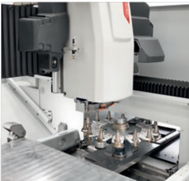
Magazzino utensili rotativo su cui è possibile caricare gli utensili in totale sicurezza mentre la macchina lavora.
