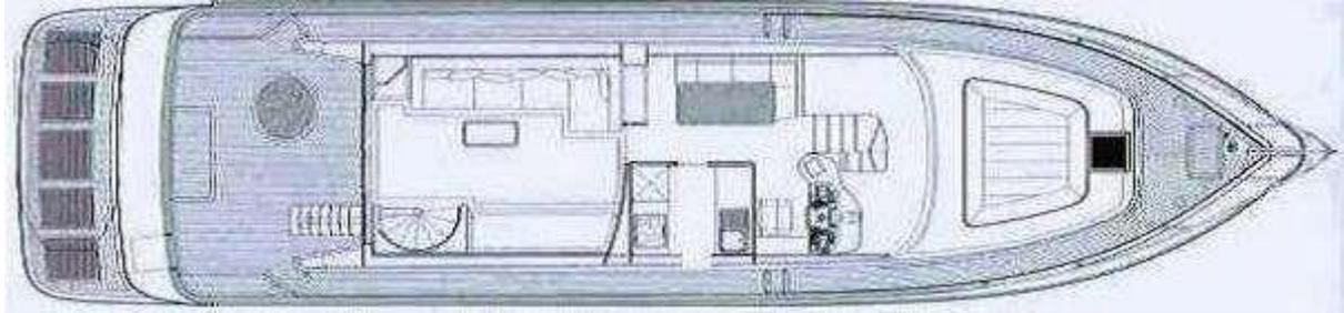
Si estende per quasi tutta la lunghezza dell' imbarcazione e vi si accede dalla scaletta di poppa, oppure dalla passerella telescopica. Le sovrastrutture sono in vetroresina e sorreggono l'Hard Top; il pozzetto, i camminamenti laterali, nonché il castello di prua sono completamente rivestiti in teak.
