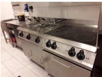
cucina a induzione 4 fuochi matricola n. CR0780799, cuoci pasta 6 cestelli matricola n. BN020178150, piano lavoro con mobile ante e lavabo
