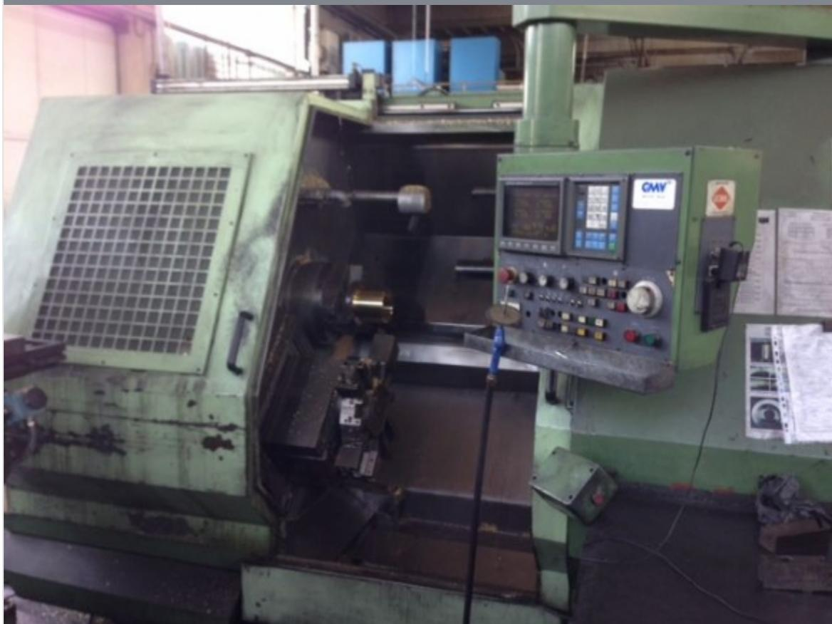
**MODELLO:** B56**TIPO:** Tornio a controllo numerico**MATRICOLA:** 1806**CNC:** FANUC 0TT**ANNO:** 1992**NOTE:** MACCHINA DA RIPRESA**CAPACITÀ**
