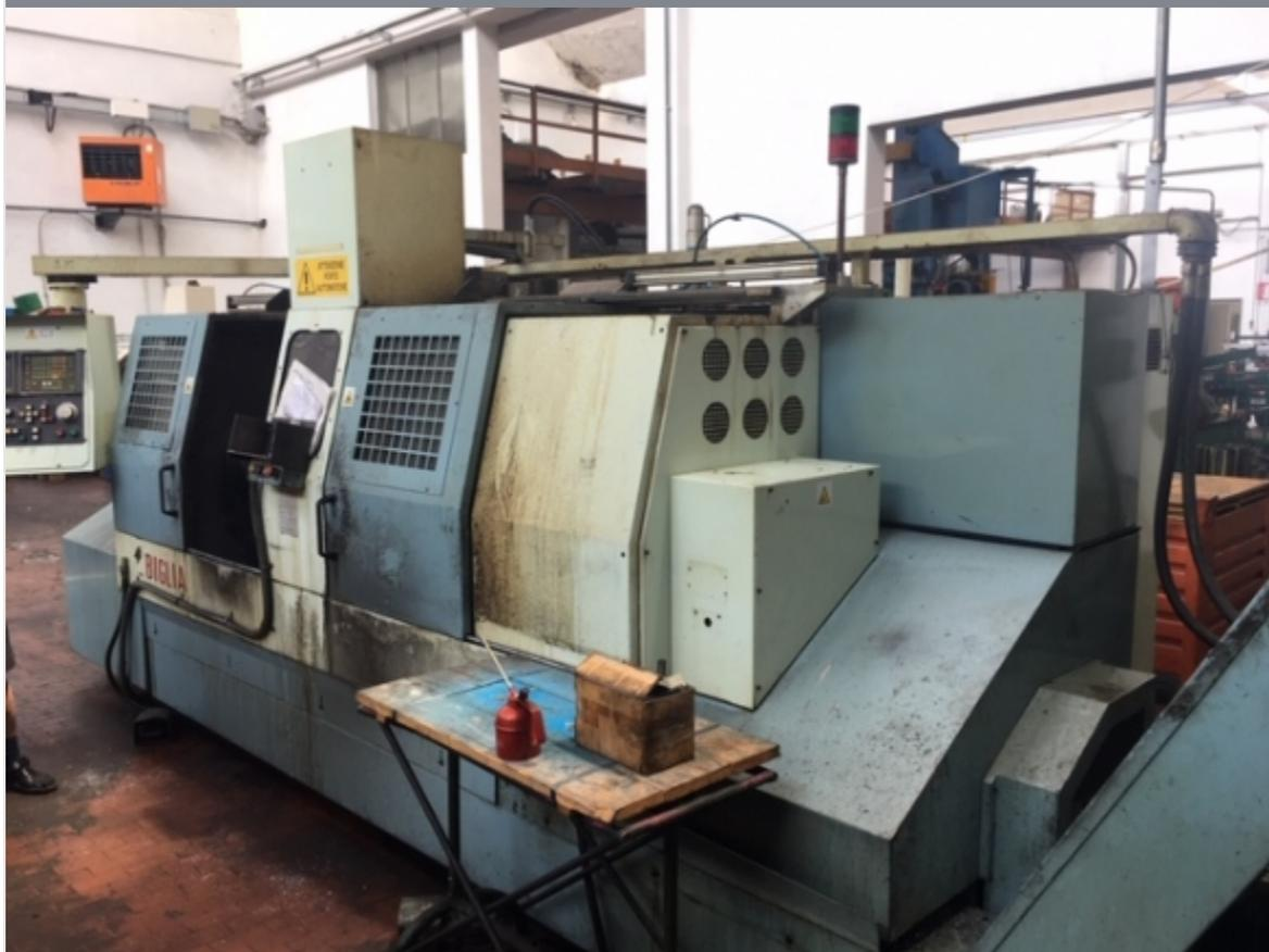
**MODELLO:** B2M**TIPO:** Bimandrino contrapposto**CNC:** FANUC 0T**NOTE:** 2 MANDRINI 1 TORRETTA PER LAVORAZIONI IN PENDOLARE**CAPACITÀ**
