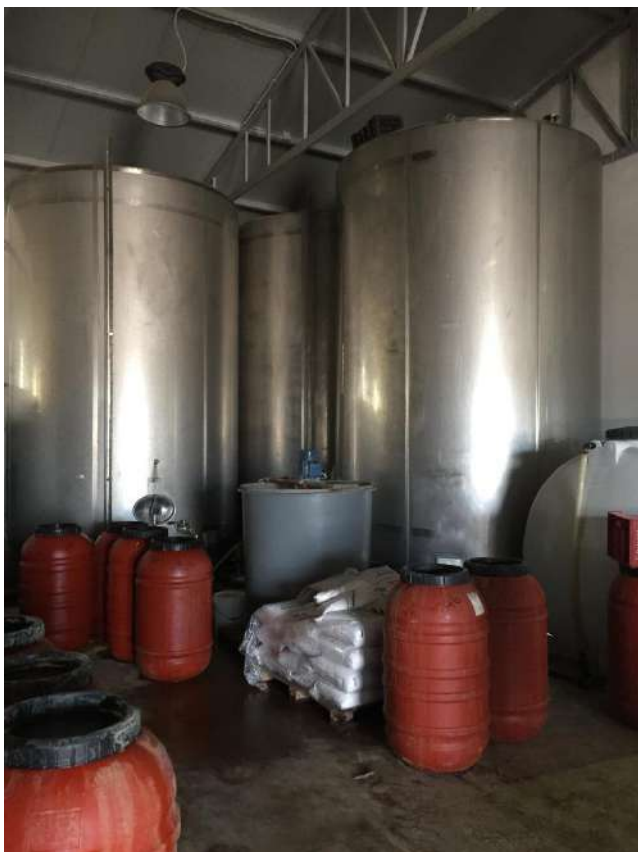
4 N° 3 silos in acciaio da 300 hl
