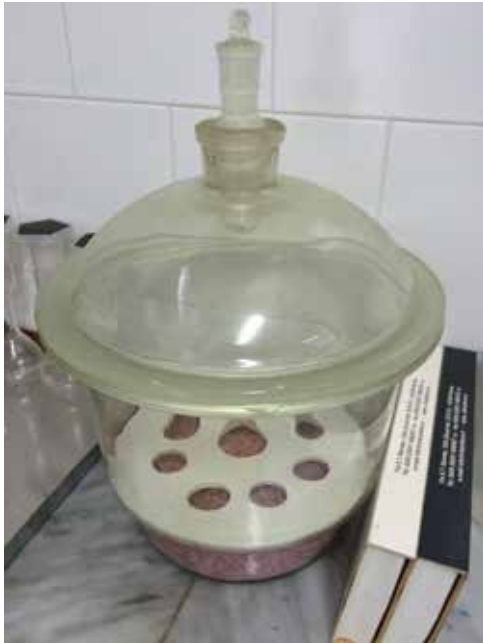
197. Contenitore in vetro con coperchio e tappo erogatore, detto essiccatore (Edificio A - P. Terra zona laboratorio)
