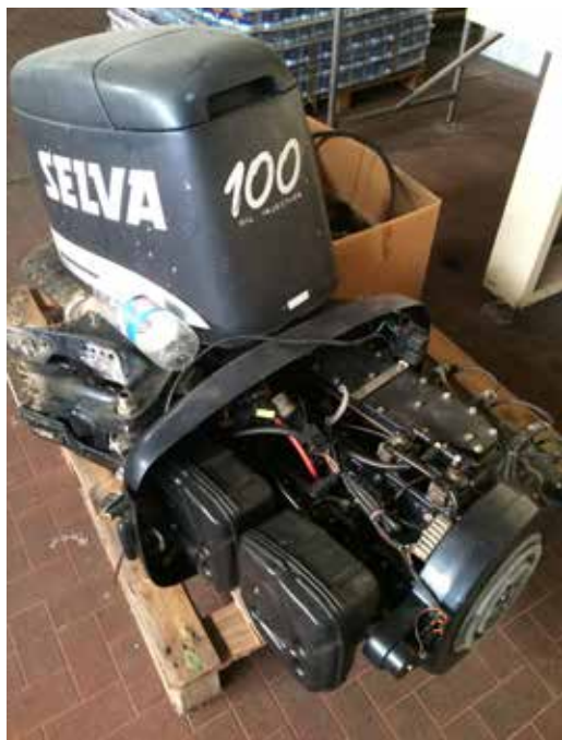
54. Motore 100 cavalli SELVA Montecarlo, iniezione ad olio (Zona confezionamento - Edificio A).
