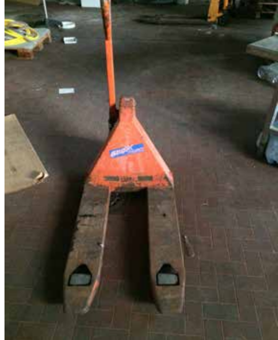
51. Carrello sollevatore e trasportatore manuale marca MASETTI (Zona confezionamento - Edificio A).
