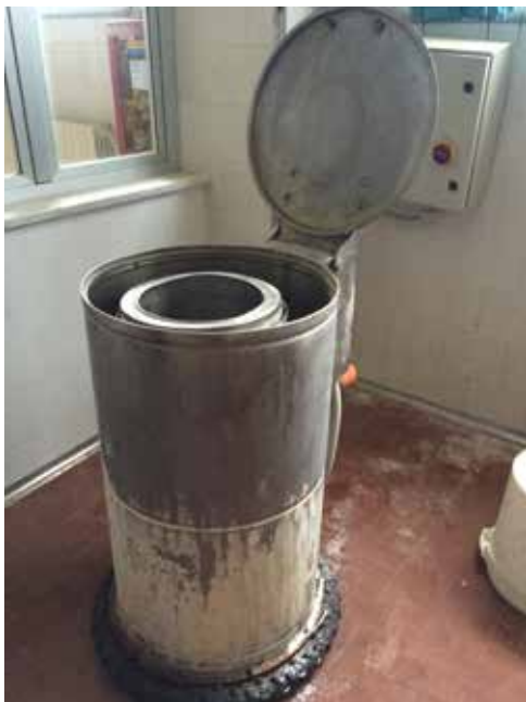
86. Cilindro in acciaio con coperchio e cestello girevole interno (possibile centrifuga), collegato alla presa elettrica (Edificio A - 1° Piano)
