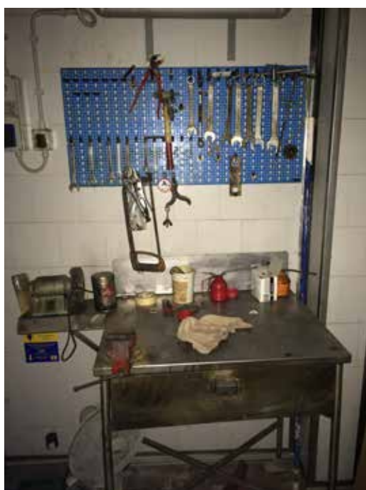
71. Banco da lavoro in acciaio con cassettone 0,8 m x 0,6 m x 0,9 m completo di attrezzi da lavoro (Zona confezionamento - Edificio A).
