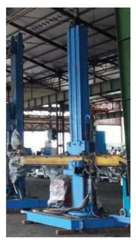
MANIPOLATORE Usato tipo Armco 4x4 realizzato in robusta carpenteria meccanica particolarmente indicato per tutte le applicazioni di saldatura automatica per l'esecuzione di saldature longitudinali e circonferenziali, interne ed esterne di corpi cilindrici, eolico e carpenteria in genere.
