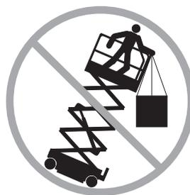
Non posizionare o fissare pesi o carichi sporgenti su nessuna parte della macchina.
