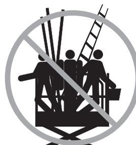
Non posizionare scale o ponteggi all'interno della piattaforma o contro qualsiasi parte della macchina.
