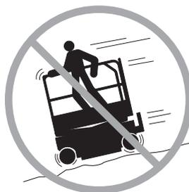
Ridurre la velocità di traslazione in base alle condizioni del suolo, alla situazione del traffico, alle pendenze, alla presenza di personale e ad altri fattori che possono essere causa di collisioni.
