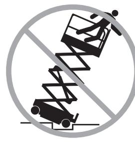
Utilizzare estrema cautela e velocità ridotta quando la macchina viene spostata con la piattaforma retratta su superfici non livellate, instabili, con detriti o scivolose, e in prossimità di fossati e dirupi.
