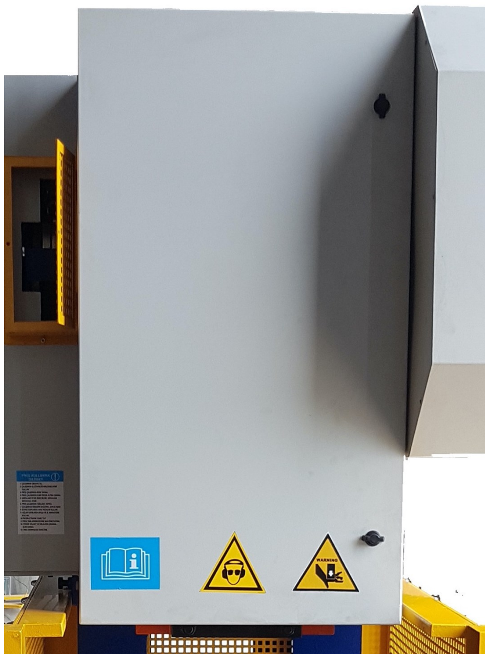
Figura 37: Coperchio frontale a protezione da albero eccentrico e biella
