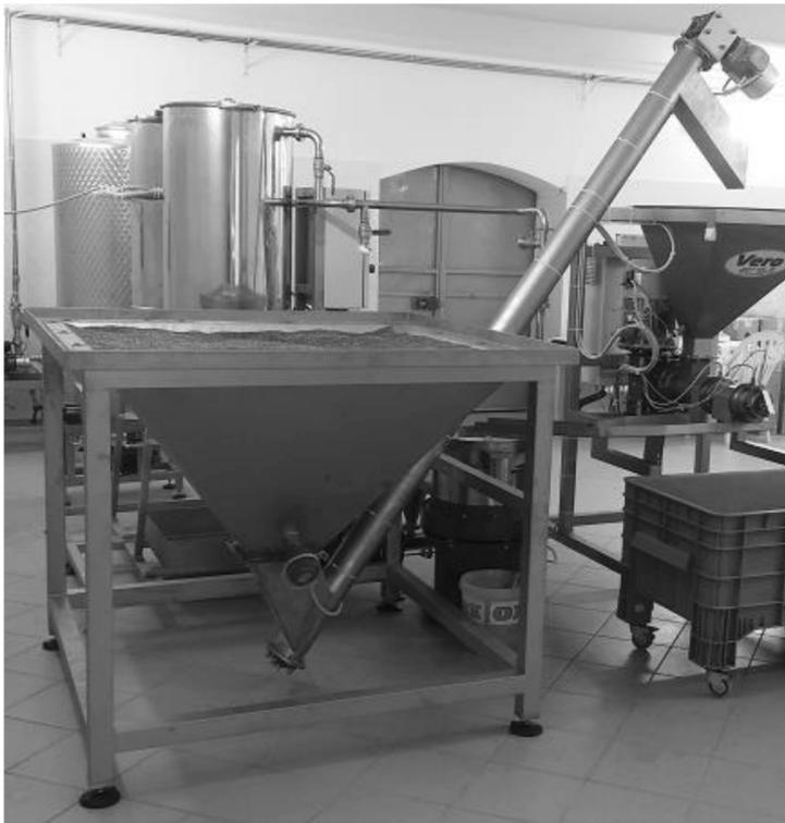
Caricatore a coclea per semi oleosi, dotato di tramoggia di accumulo per aumentare l'autonomia operativa delle macchine spremitrici per semi oleosi.
