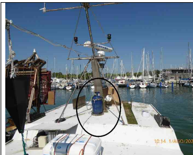
Fotografia 77 – Posizione della bombola gas cucina
