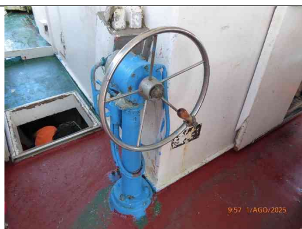
Fotografia 6 – Seconda postazione di manovra
