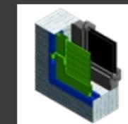
Montaggio a finestra al telaio su serramento
