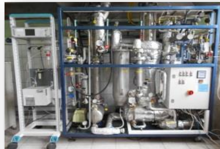
Stanowisko laboratoryjne usuwania CO 2 – 5 m 3 /h (2011)
