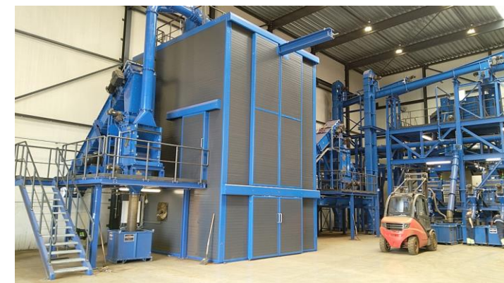
Przykład: instalacja 5t/h –separacja silników elektrycznych
