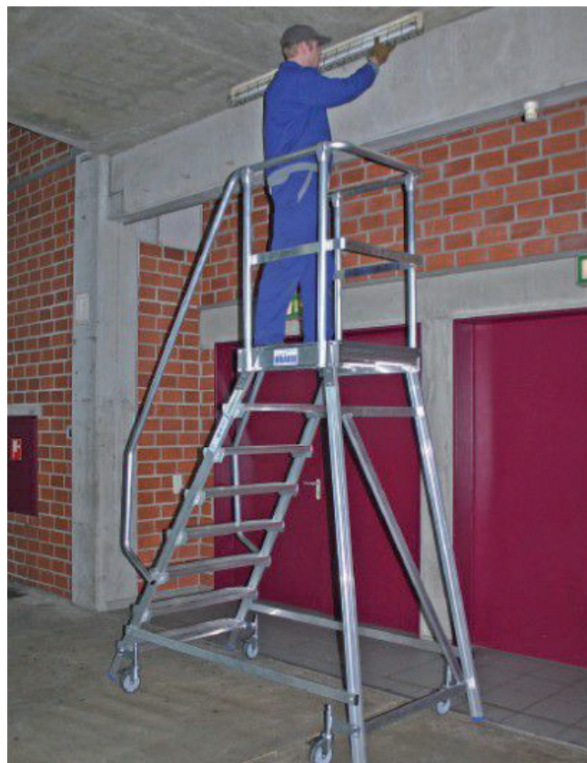
Rys. 3. Praca na pomostie przejezdnym (krauze.system.pl)
