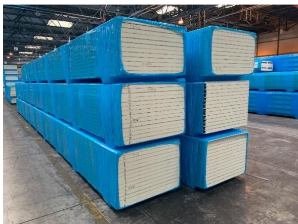
Fot. 1 Pakowanie płyt ściennych
