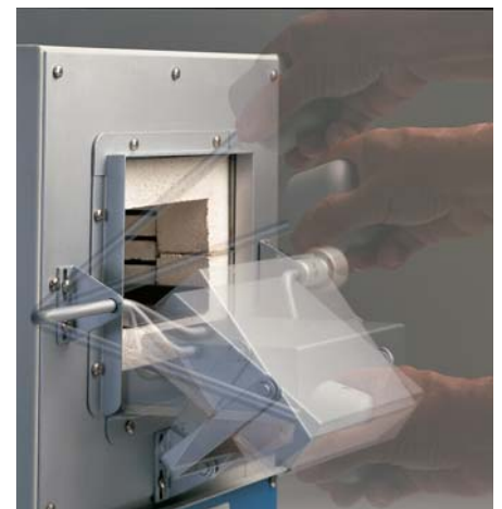
Detalle del sistema de apertura basculante.
