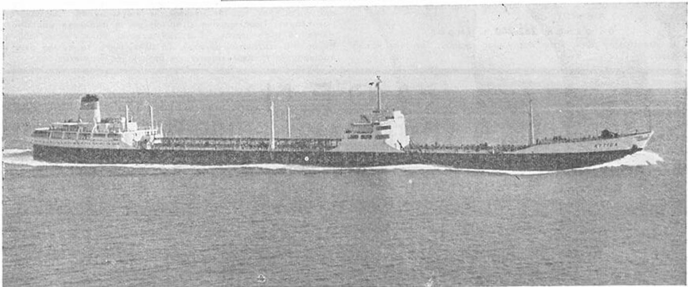
Τὸ ἰαπωνικῆς κατασκευῆς νεότευκτον (ναυπηγεῖα Χαρίμα) δεξαμενό πλοῖον «ΑΤΤΙΚΑ», τόννων δ.μ. 47.000, ταχύτητος οικονομικῆς 16,5 μιλίων, μὲ δύναμιν μηχανῆς (ἀτμοστρόβιλοι), 17.600 ἵππων. Μήκος ὀλίγον 734,1 πόδες. Πλάτος 100,1. ὕψος 49,10. Βύθισμα 37,3 πόδες. Παρεδόθη τὴν 25ν ὀκτωβρίου εἰς τοὺς ἰδιοκτήτας του (διαχειρίσει Ν. Γ. Γουλιανδρῆ). Σημαία ΕΛΛΗΝΙΚΗ. Ἐνηολογήθη εἰς τὴν Ἄνδρον.
