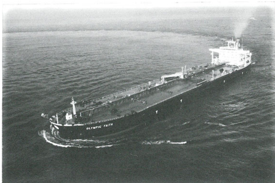
Παραλήφθηκε στις 12 Σεπτεμβρίου 1991, από τα ιαπωνικά ναυπηγεία το δεξαμενόπλοιο «Ολύμπικ Φλαίρ» 145.284 τόν. d.w., 81.400 τόν. γκρός, αδελφό του εικονιζόμενου «Ολύμπικ Φαίηθ», εφοδιασμένο με double bottom.
