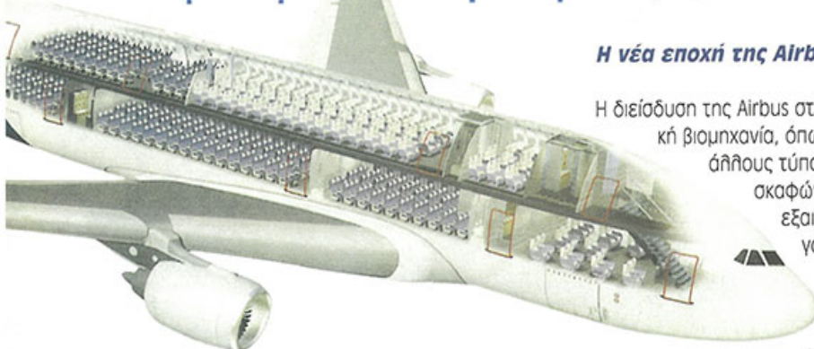
Σχέδια από την Airbus του νέου A3XX, που θα έχει τη δυνατότητα να φιλοξενεί 555 επιβάτες σε δύο διαφορετικά επίπεδα
