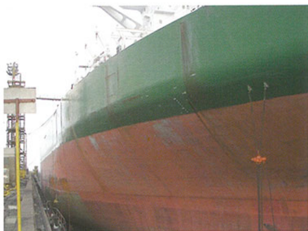
Το M/V «Ramiah» κατά τη διάρκεια καθαρισμού στη δεξαμενή του Dubai, ύστερα από λειτουργία 61 μηνών
