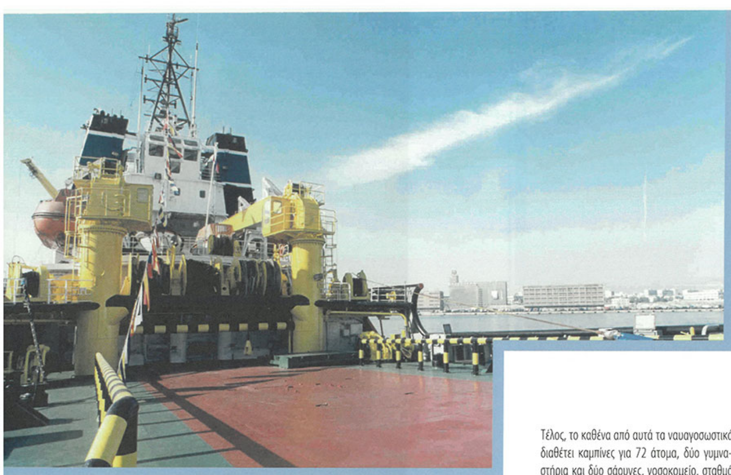
Κατάστρωμα Nikolay Chiker: (στο βάθος) Ο εξοπλισμός έλξης που περιλαμβάνει δύο και ένα δευτερεύον βαρούλκα ρυμούλκησης με διπλές ανέμες και με συρματόσχοινο 1.500 μέτρων
