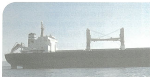
Φωτογραφία 1. Handymax με δικά του μέσα φορτοεκφόρτωσης (geared). Πηγή: Atlantic Bulk Carriers Management Ltd.
