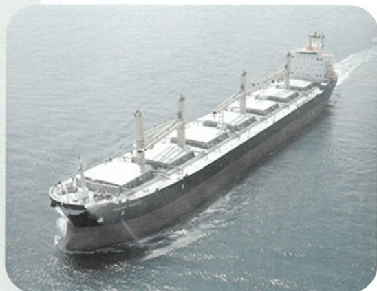
Φωτογραφία 2. Panamax με δικά του μέσα φορτοεκφόρτωσης (geared). Πηγή: Atlantic Bulk Carriers Management Ltd.
