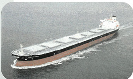
Φωτογραφία 3. Panamax χωρίς δικά του μέσα φορτοεκφόρτωσης (gearless). Πηγή: Atlantic Bulk Carriers Management Ltd.
