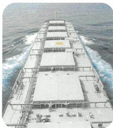
Φωτογραφία 4. Αποψη του κυρίου καταστρώματος Panamax (gearless). Πηγή: Atlantic Bulk Carriers Management Ltd.
