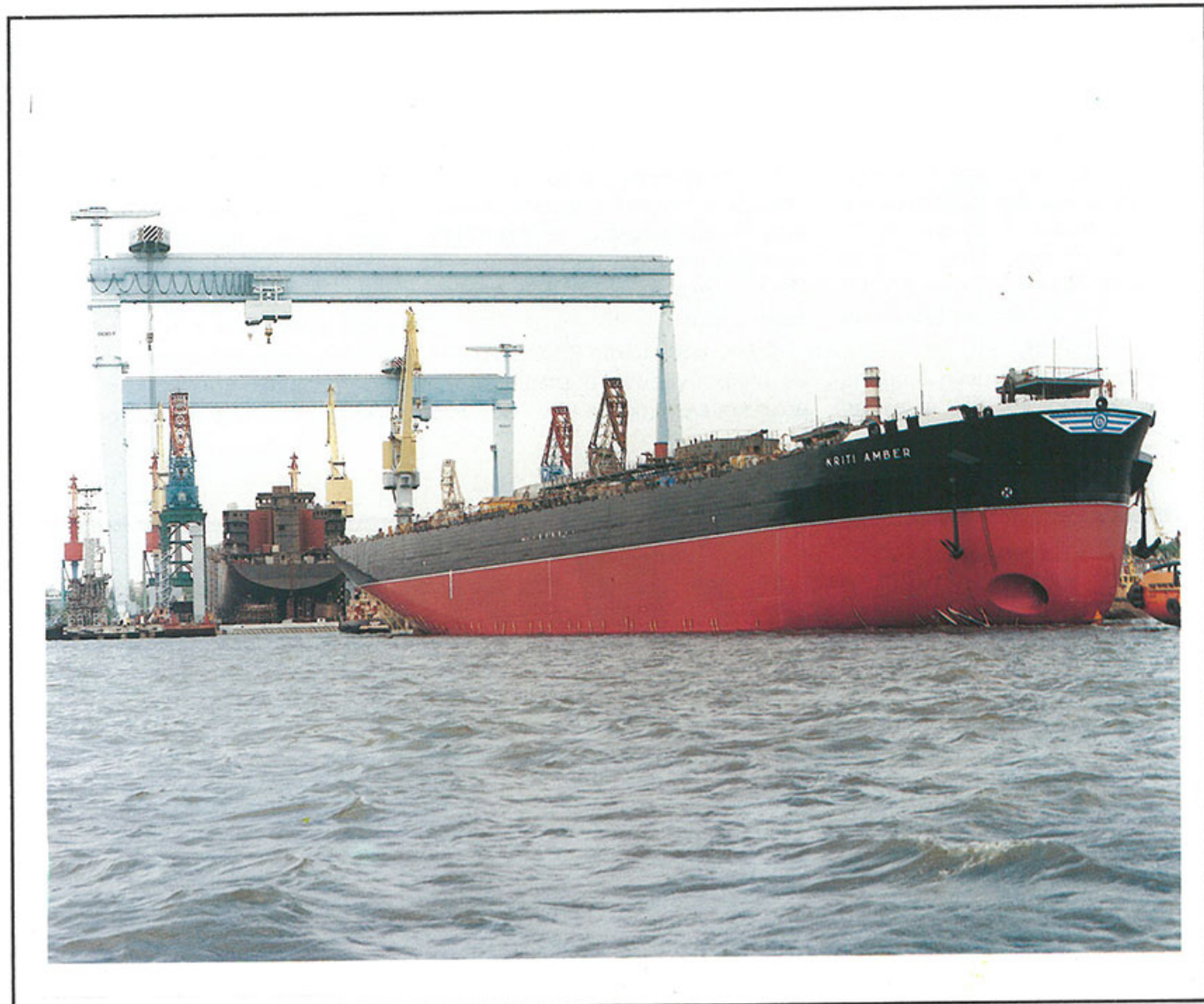
Το πρόντακτ κάρριερ «Κρήτη Αμπερ» αμέσως μετά την καθέλκυσή του, ενώ διακρίνεται η άλλη ναυπηγική εσχάρα του ναυπηγείου BSSY στην οποία βρίσκεται σε προχωρημένο στάδιο η ναυπήγηση του δεύτερου πλοίου της σειράς.
