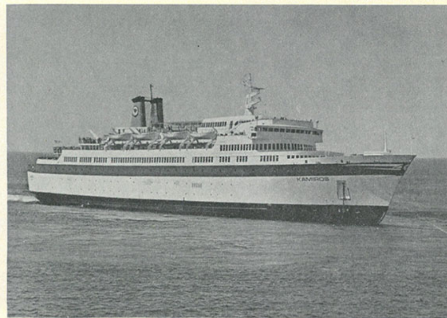
Τό επιβατηγό/όχηματαγωγό «Κάμιρος» της Δ.Α.Ν.Ε., μεταφορικής ικανότητας 1.290 επιβατών, 42 φορτηγών και 100 ιδιωτικών αυτοκινήτων.
