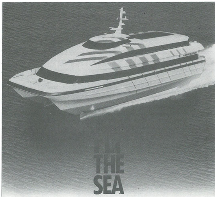
Το Foilcat, σύμφωνα με καλλιτεχνικό σχέδιο, σε πλήρη ανάπτυξη της ταχύτητας των 50 κόμβων.
