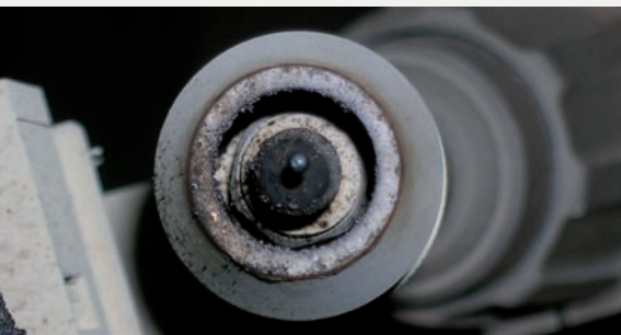
Het verschil mét en zonder de bescherm laag, na 75 minuten lassen
