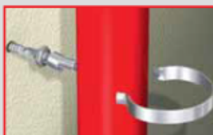
Beugel openbuigen en om de buis dichtbuigen.
