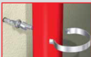
Beugel openbuigen en om de buis dichtbuigen.
