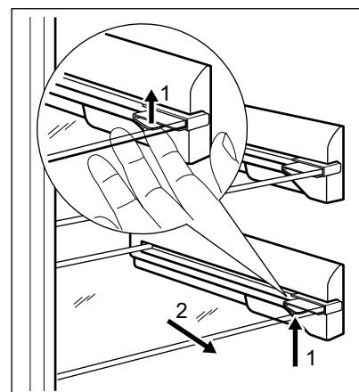
De glazen legplanken die uitgerust zijn met uitschuifbare rollers zijn bevestigd d.m.v. slotpennen. Om deze te verwijderen gaat u als volgt te werk:
