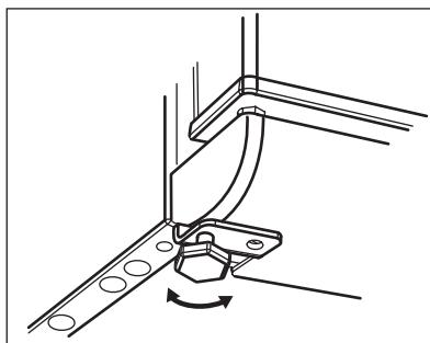
Zorgvuldige horizontale afstelling voorkomt trillingen en lawaai van de machine tijdens de werking. Om de hoogte van het apparaat aan te passen, spant u de twee voorvoetjes meer of minder aan.
