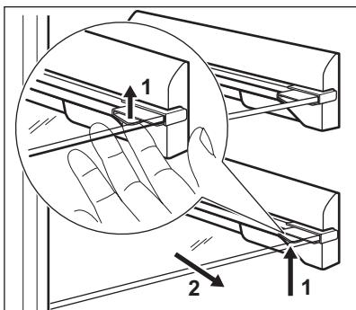
Die Ablagen des Geräts sind mit Anschlägen ausgestattet, die zu ihrer Sicherung dienen.
