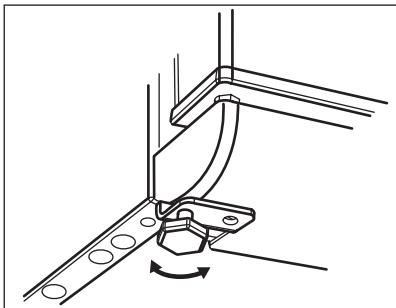
Durch eine genaue waagrechte Ausrichtung lassen sich Vibrationen und Geräusche während des Betriebs minimieren. Lösen oder ziehen Sie zum Ausrichten des Geräts die beiden vorderen Schraubfüße an.
