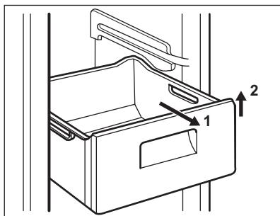
Einige der Gefrierkörbe sind mit einem Anschlag ausgestattet, der ein versehentliches Herausziehen oder ein Herausfallen verhindert. Um einen Gefrierkorb aus dem Gefriergerät zu nehmen, ziehen Sie den Korb in Ihre Richtung, bis er den Anschlag erreicht. Dann kippen Sie den Korb an der Vorderseite nach oben, bis er sich herausnehmen lässt. Wenn Sie den Gefrierkorb wieder zurück in das Gerät einschieben möchten, heben Sie die Vorderseite des Korbs leicht an und setzen ihn in das Gefriergerät ein.
