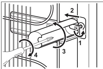
U vindt de twee afstandhouders in de zak van de gebruikershandleiding. Volg deze stappen om de afstandhouders te installeren:
