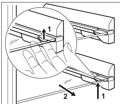
Het apparaat is uitgerust met palletjes om de glasplaten vast te zetten. De platen moeten worden opgetild (1) aan elke kant en dan naar achteren worden getrokken (2).
