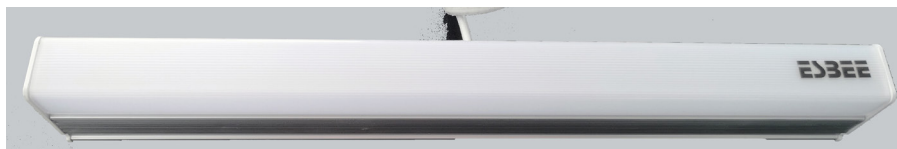
PB13 Φωτιστικό πίνακα 9W 30cm 230VAC 750lm, προστασία υπερτάσεων 2KV, χρόνο ζωής 25-30.000hrs, 0-50°C, IP20, 27cm
