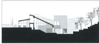
La piezas se distribuyen en distintos niveles para establecer una relación directa con las cotas del cambiante terreno. El quebrado perímetro de la planta proporciona las mejores vistas y aumenta las horas de soleamiento.
