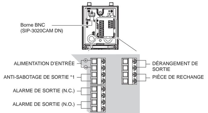
\*1: bornes anti-sabotage à connecter à une boucle de supervision 24/24.
