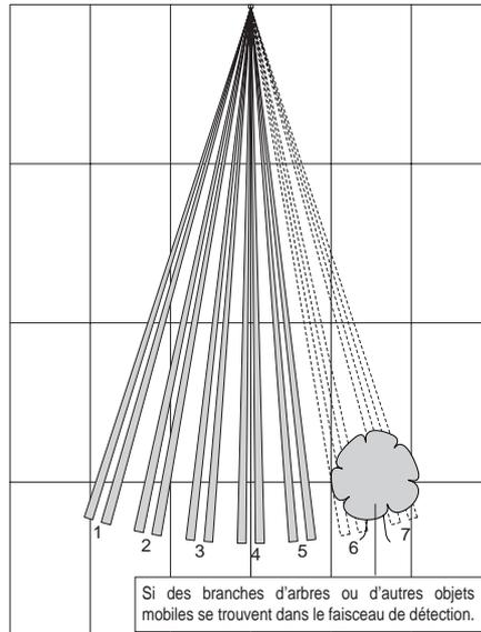
Si des branches d'arbres ou d'autres objets mobiles se trouvent dans le faisceau de détection.
