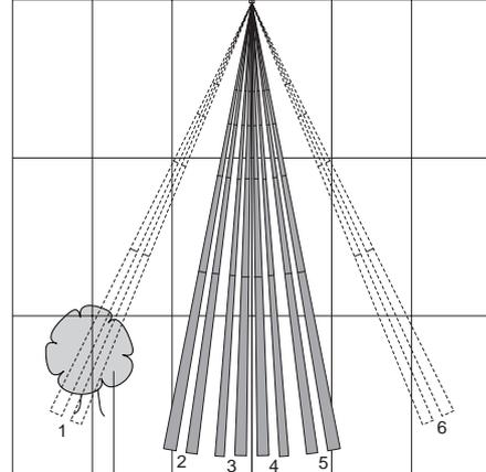
Si des branches d'arbres ou d'autres objets mobiles se trouvent dans le faisceau de détection.
