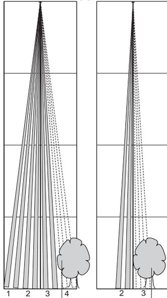
Si des branches d'arbres ou d'autres objets mobiles se trouvent dans le faisceau de détection.
