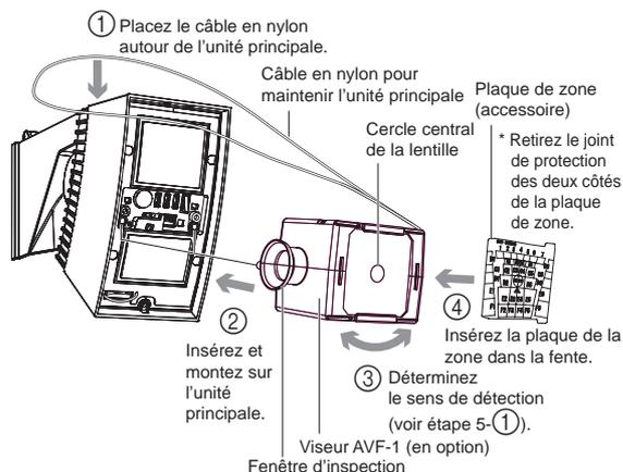
**(3) Localisez le cercle central de la plaque de zone sur le cercle central de la lentille du viseur puis vérifiez le modèle de la zone de détection sur la plaque de zone et l'image en arrière-plan.**
