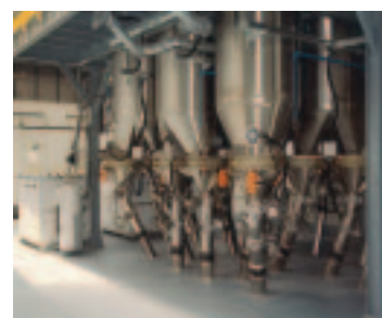
La nuova tecnologia CCM (Continuous Compound Mixing) integrata nell'impianto MIRS™ di Milano Bicocca.
