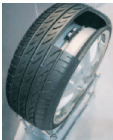
Il sistema X-Pressure per la rilevazione della pressione all'interno del pneumatico.
