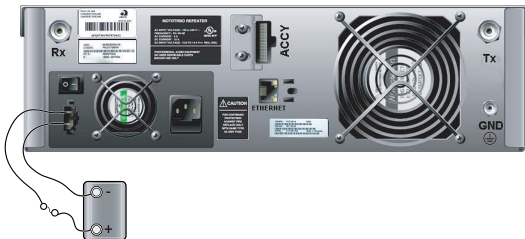
Figura 4-2 Realización de conexiones en una batería de repuesto
