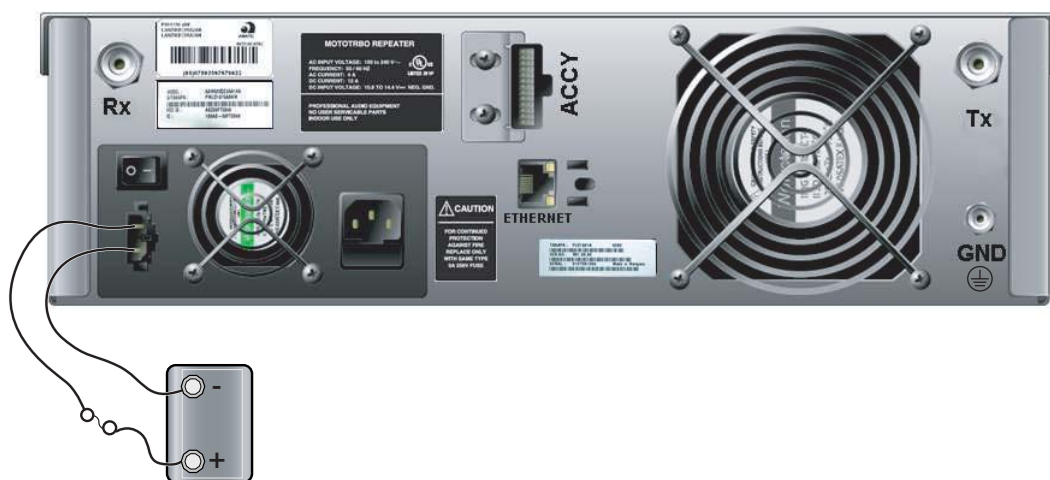
Figure 4-2 Raccordement à une batterie de secours
