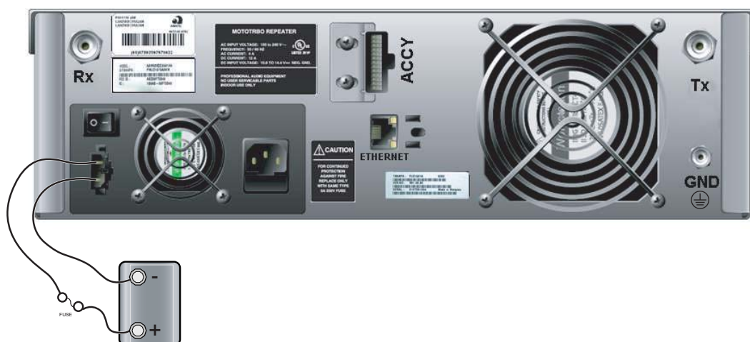
Abbildung 4-2 An einen Zusatzakku anschließen
