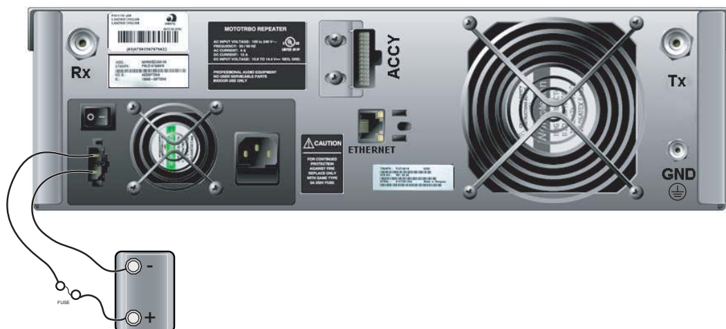
Figura 4-2 Modalità di collegamento della batteria di backup
