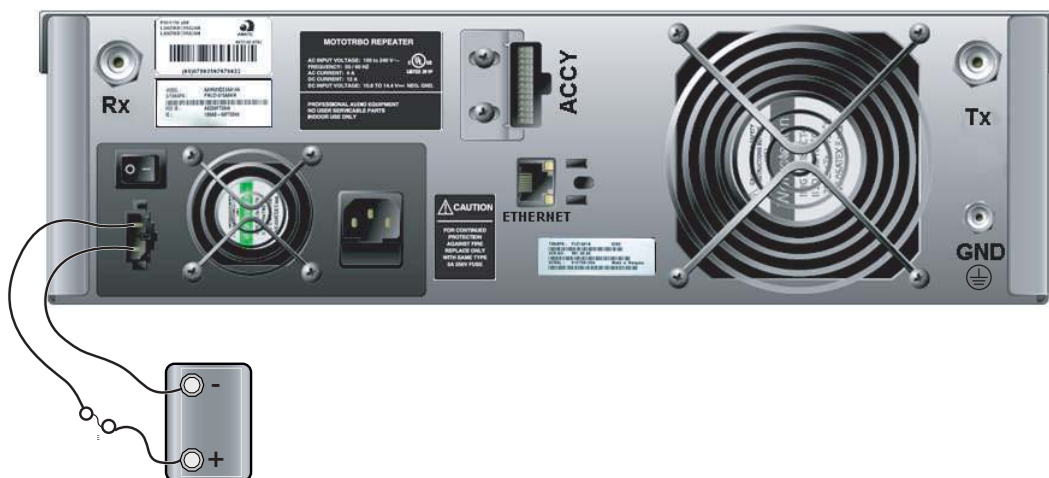
Рис. 4-2 Подключение резервного аккумулятора
