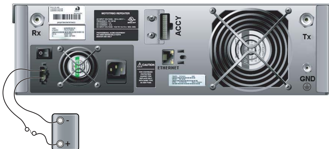
Rysunek 4-2 Wykonywanie podłączenia do rezerwowego zasilania akumulatorowego
