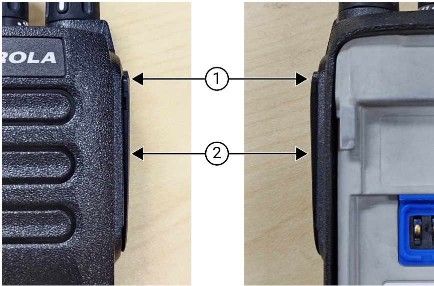
Figure 3 : Cache anti-poussière non fixé correctement
