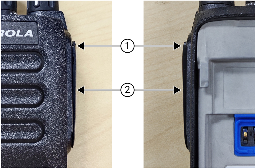
Figure 3 : Le couvercle antipoussière n'est pas fixé
