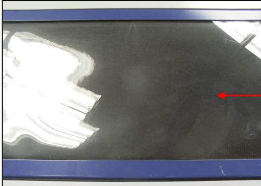
Compruebe que la visión del componente cuyo aire vaya a limpiarse no esté dificultada por una lámina contra la formación de escarcha sucia (**P2PF0008 o P2PF0005 en el caso de Formula 1200**) o el vidrio (**P2GL0008 o P2GL0001 en el caso de Formula 1200**). Sustituya las piezas necesarias.
