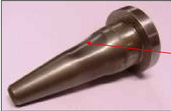
La boquilla de aire debe quitarse del cuerpo de la pistola después de 8 horas de chorreado para establecer el patrón de desgaste en su superficie externa. Cuando el desgaste sea evidente, el accesorio deberá girarse hasta la siguiente sección no usada. Cuando se produzca desgaste alrededor de toda la circunferencia, deberá sustituirse la boquilla de aire.
