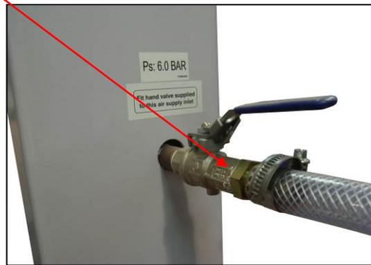
Asegúrese de que el material de ensamblaje (p. ej., cinta de PTFE) no entre en la canalización.
