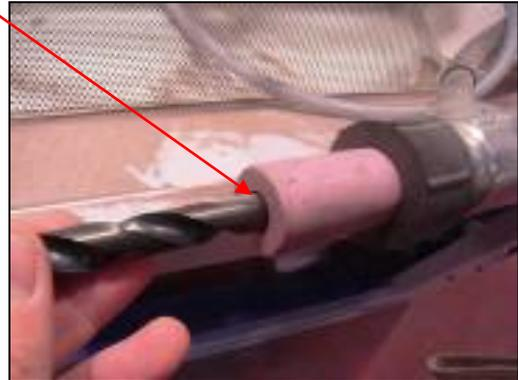
La siguiente imagen muestra una boquilla extremadamente desgastada. Su boquilla no debería alcanzar este estado, ya que se reducirá la efectividad del chorreado y también podría dañarse la pistola de chorreado.
