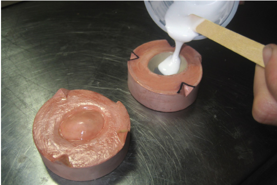
FIG. 10.15 Filling mold halves
