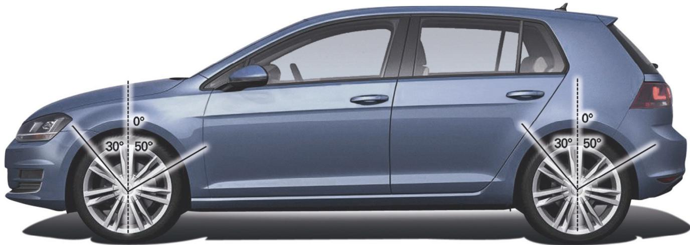
In dem Teil, der durch die Radialebenen 30 ° vor und 50 ° hinter der Radmitte gebildet wird, muss die Gesamtbreite der Radabdeckungen mindestens ausreichen, um die Breite des Reifens abzudecken.
