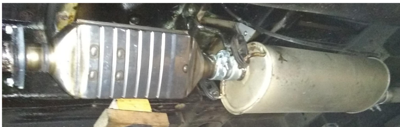
Eksempel 1: Lydpotte drejet 180° så original ophæng anvendes. (Foto: Bilmageriet)
