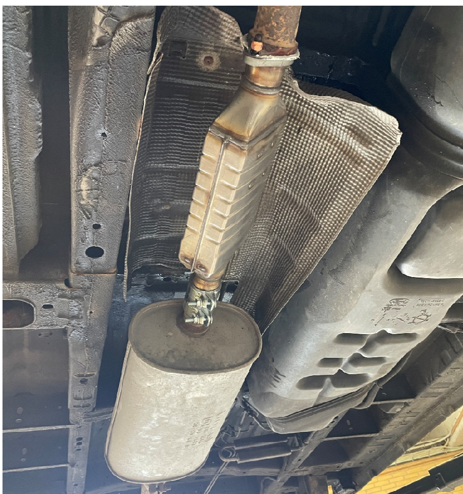
Eksempel 3: Lydpotte sænket og monteret direkte på DPF (Foto US Auto)
