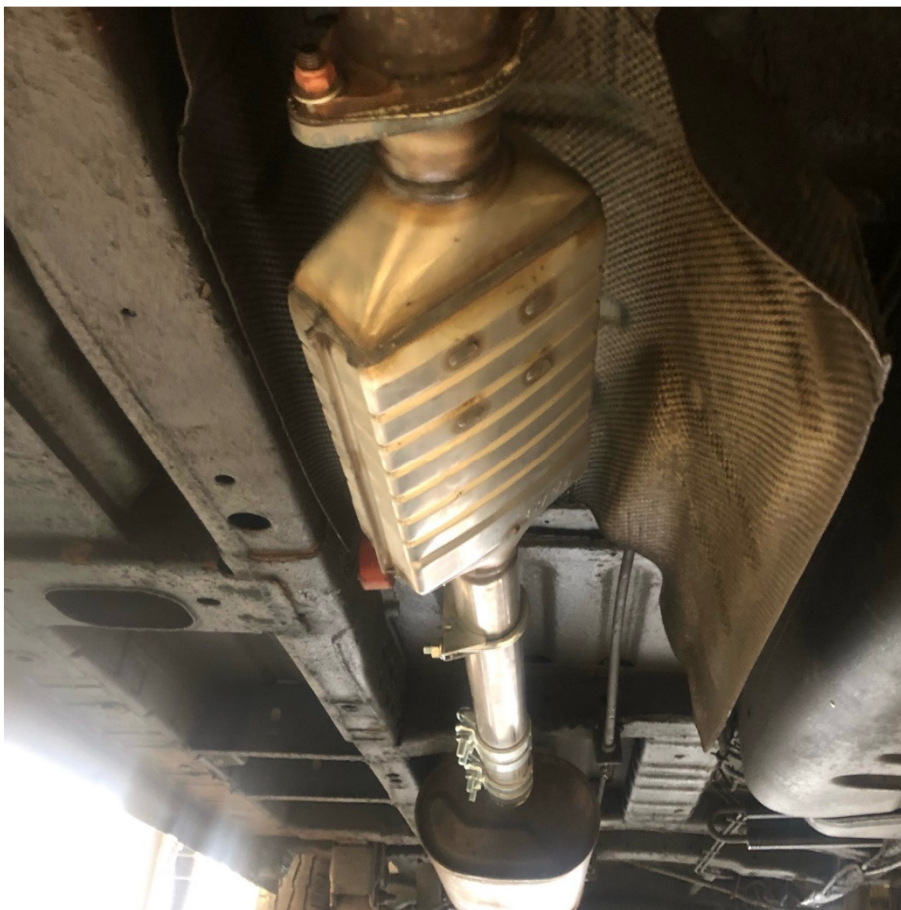
Eksempel 2: Lydpotte er rykket langt bagud aht. tværvanger (Foto: Hune Auto)
