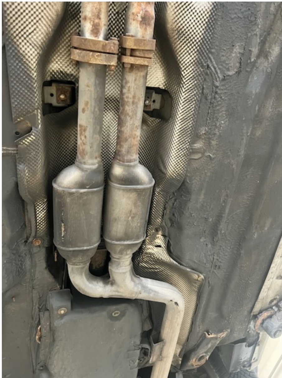
Billede af de original udstødning med 2 mellempotter. Filteret monteres derfor nemmest længere fremme på højreside af gearkasse.
