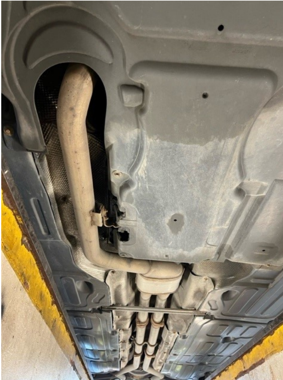
Udstødning med enkelt mellempotte med split til 2 bagrør. Partikelfilteret monteres nemmest på højre side af gearkasse ved beslaget.
