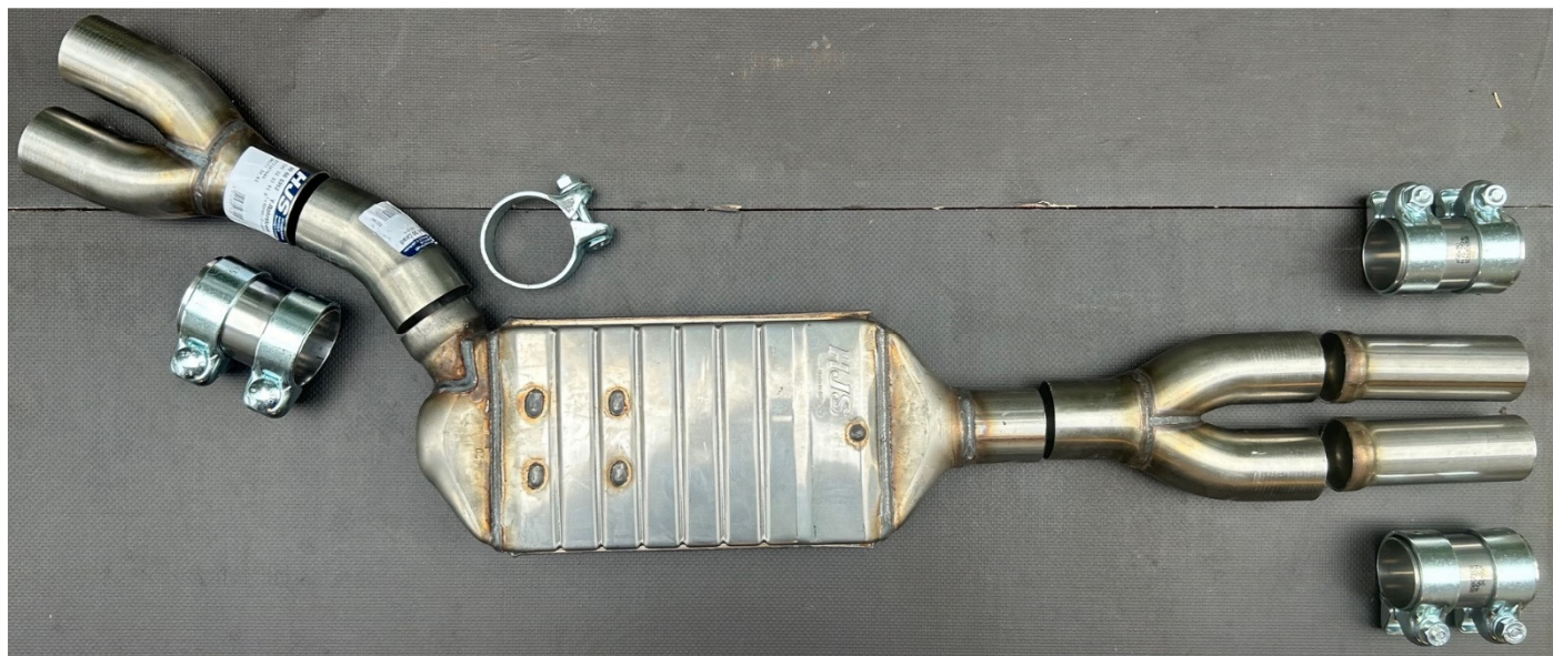
Originalt for-katalysator(1) og 2 parallelle katalysatorer på forrør (2). Partikelfilteret erstatter de 2 katalysatorer på forrør.
