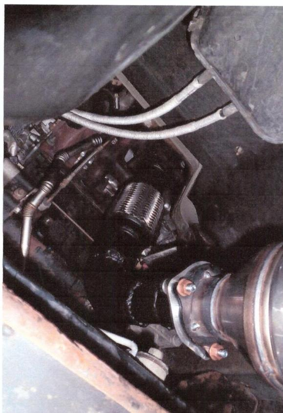
*Je nach Ausführung und Radstand kann es nötig sein den Mittelschalldämpfer leicht zu versetzen, um die Passung des Systems zu gewährleisten.*
