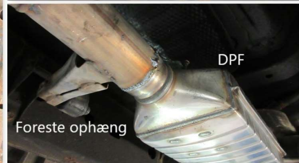
Eksempel på montering på nyt mellemrør og lydpotter. Placering af de 2 ophæng bevaret.
