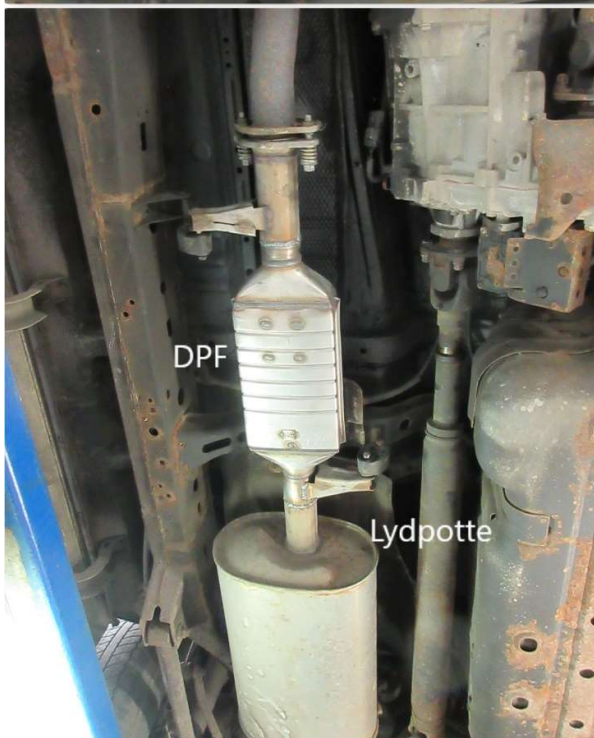
Eksempel på montering på nyt mellemrør og lydpotter. Placering af de 2 ophæng bevaret.
