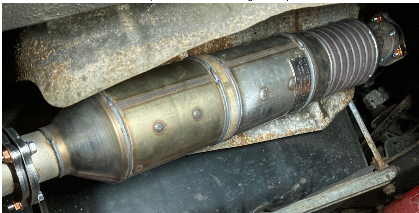
Monteres på forrør. Erstatte evt. original katalysator.
