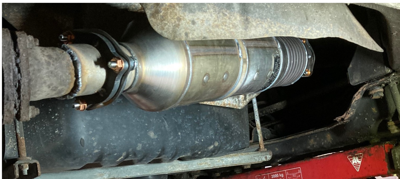
Monteres på forrør. Erstatte evt. original katalysator.
